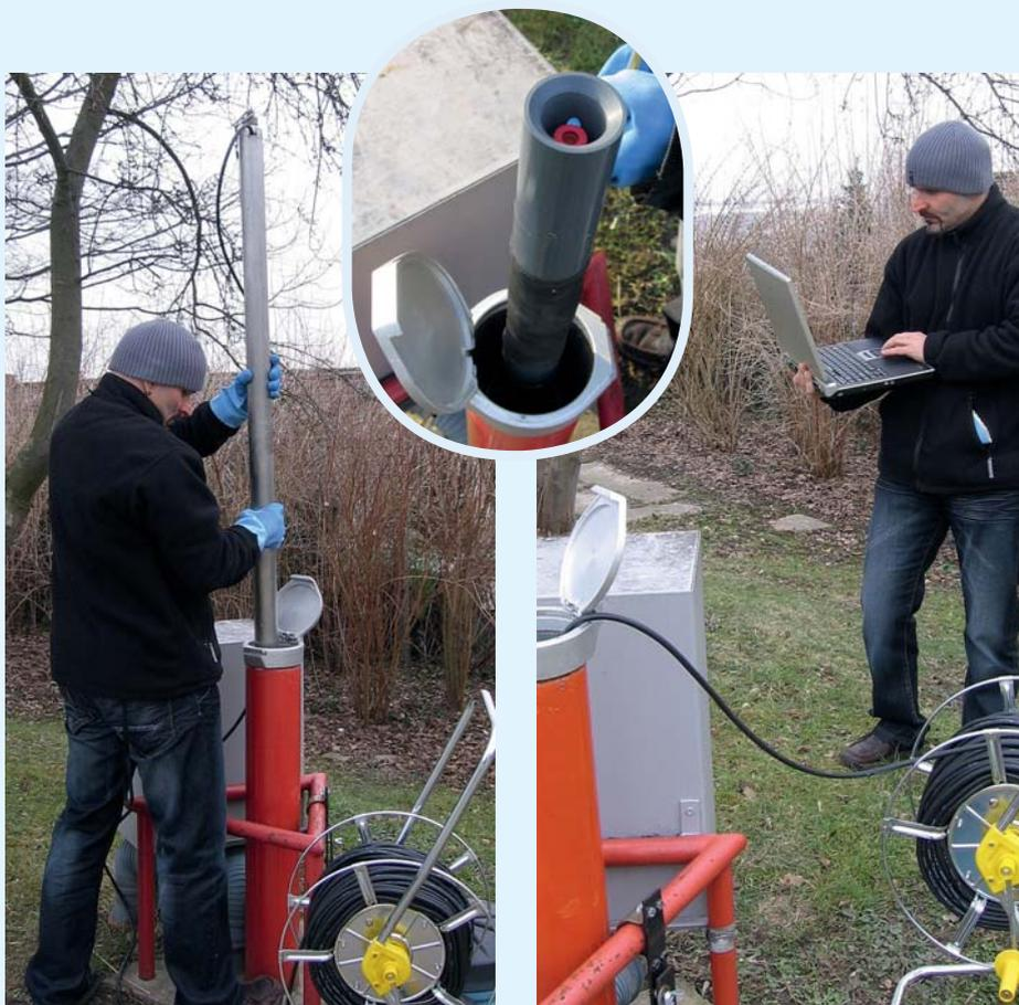
**HANDHABUNG:** Die GWMon-Station wird in der Messstelle installiert (oben), das GW-Shuttle eingefahren (links) und die Probenahme drahtlos per Notebook gesteuert (rechts) Foto: DGFZ Bild 2
