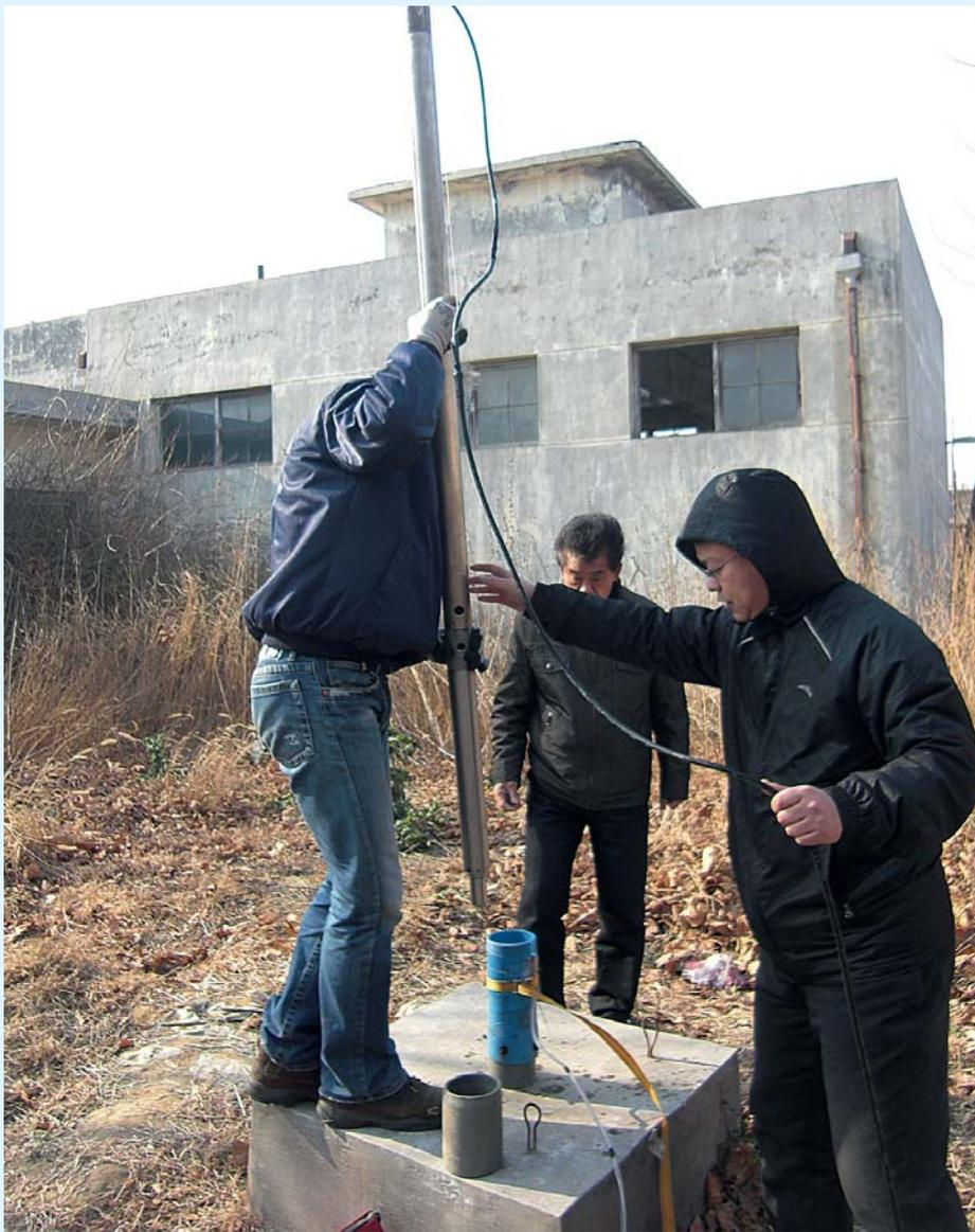
**EINSATZ IN CHINA: Probenahme mit dem GW-Shuttle** Foto: UGT Bild 4
